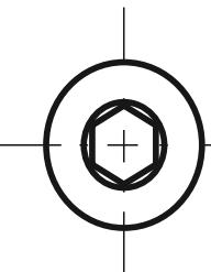
Šrouby se zapuštěnou hlavou a vnitřním šestihranem, (podle normy DIN 7991 10.9)
